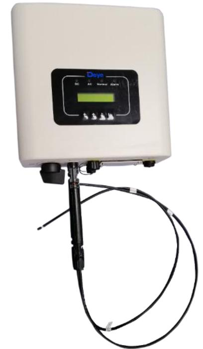
*Imagen real de un inversor Huawei con la anterior línea de conectores con fusible Eastech*
